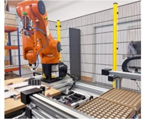
Hochwertig bestückte Platinen und robuste Zellverbinder sollen fehlerlose Funktion und Langlebigkeit garantieren – der Roboter selektiert nur beste Zellen und bestückt die „Zellhalter“ der Snettbox.
